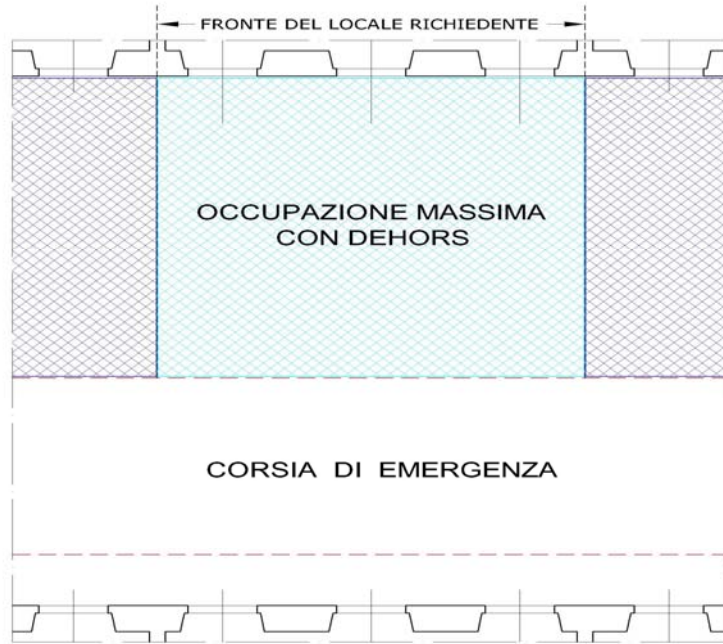
Fig. 5 – Esempio di occupazione con superficie contenuta nel fronte del locale (caso 1)
